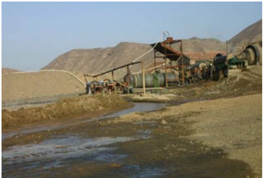
乱開発。鉄鉱石の選別と洗浄のために貴重な水源が汚染されている。
